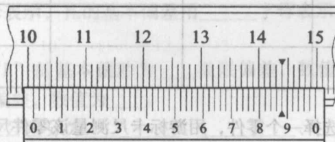
图 1—5 识读游标卡尺的示值二
