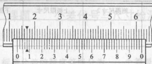
图 1—4 识读游标卡尺的示值一
