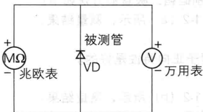
图 1-4 用兆欧表和万用表检测二极管的反向击穿电压
