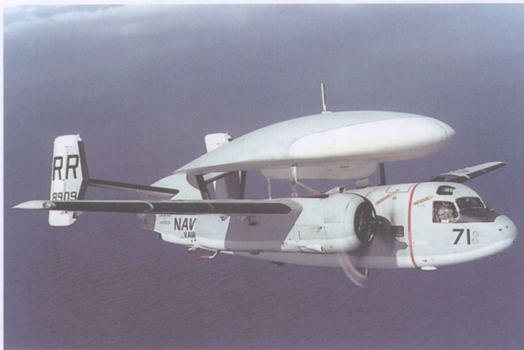
E-1“跟踪者”预警机是基于S-2“追踪者”反潜机的基本架构演变而来，在飞机顶部增加了大型固定式椭圆形结构
