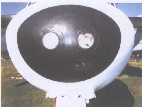
E-2B机头部分安装在机身上。卸下周围的安装支架后，即可对2盏滑行灯和3个指示灯面板进行维护
