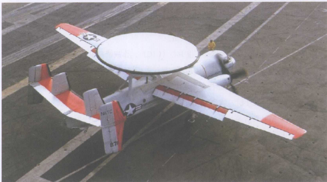
E-2A(148711)在海军航空实验中心（NATC）进行机型航母适应性测试。飞机翼尖和大部分尾翼表面均喷涂了橙色荧光漆
