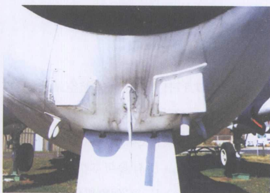
这张机头部分图片显示了1个刀型天线、2个排水结构以及位于下部的2个固定锁环
