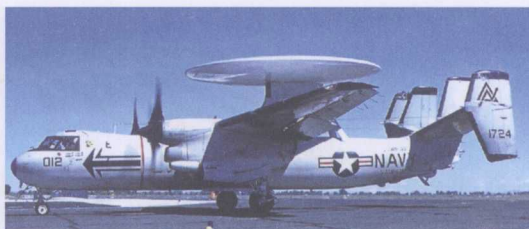
E-2B预警机分属于2个预备役中队，包括西海岸的VAW-88中队，本图片所示的即为分配给该中队的编号为151724/ND-012的飞机（请注意已经固定化的“ND”编号）。机身上的箭头和翼尖整流罩的颜色为深蓝色
