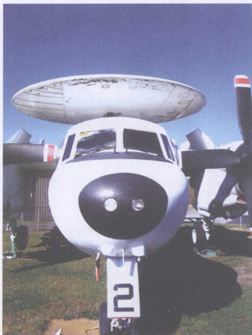
E-2B和E-2C外观上的主要差别在于机头结构。E-2B机头中部装有2个滑行灯，在滑行灯下面是2个排放孔
