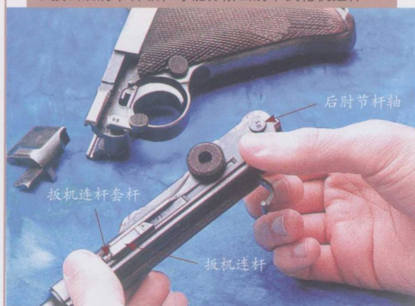
5. 拔出后肘节杆轴，才能分解出肘节式枪机组件
