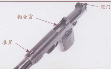
3.套筒顶部特写。抛壳窗兼作装弹口，机械瞄具采用缺口式照门和片状准星
