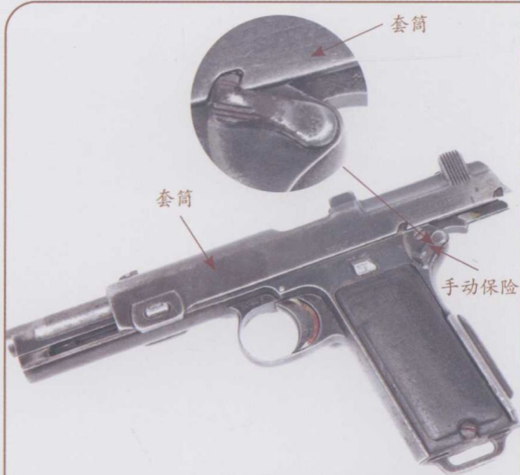
2.套筒座左侧后上方设有手动保险，手动保险有两个位置：上为保险位置，下为发射位置。该手动保险作用有二：一是在套筒处于前方位置时锁住套筒，以防止因外力作用使套筒往复运动而造成偶发；二是如图中所示的空仓挂机状态时将手动保险扳至保险位置，锁住套筒，以确保装弹的安全
