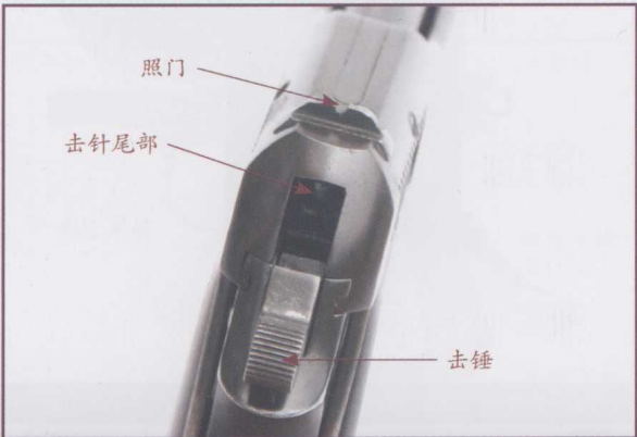
2.处于待击状态的外露击锤，套筒后方的击针尾部清晰可见，照门为方形缺口式
