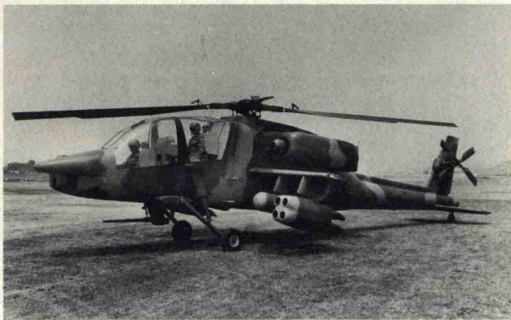
左图：面对专门攻击直升机的需求，美国休斯直升机公司拿出了77型直升机。尽管只是一架模型机，该机上展示的特点最终应用在了AH-64“阿帕奇”上。图中可以看出其串联双座设计、机头下方的机炮以及安装在塔架上的“陶”式导弹发射器。该发射器将被应用于世界各型专门攻击直升机上。
