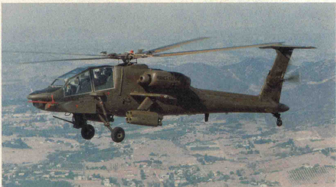
上图：图示是YAH-64的第二架原型机AV-02在早期飞行测试中，注意其机头和座舱罩的初始形状。
