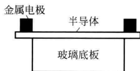
图 1.2.1 光敏电阻的原理结构
