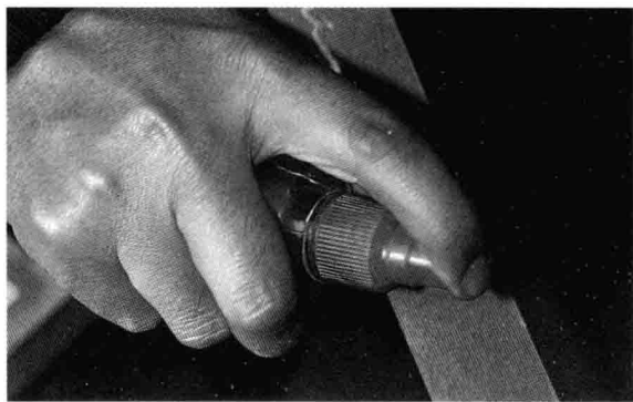
9. 用同样的方法给量好尺寸的水胶带喷水。
