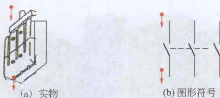
图 1-16 QS 刀开关 (胶盖闸) 实物与接线图形符号
