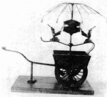
度量空间的工具——据文献复原的西晋计里鼓车
