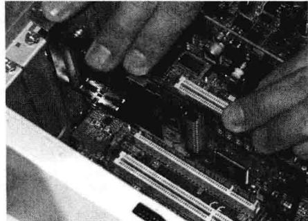
将网卡轻轻插入对应的插槽内，使网卡引脚与插槽正常接触，用螺丝钉将网卡固定好，最后安装好机箱盖即可。
