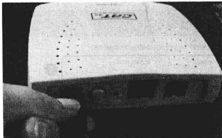
将 ADSL Modem 的电源线插入左侧的接口中，将另一端插到电源插座上。
