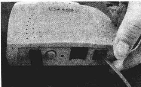
将电话线的一端插入 ADSL Modem 的“Line”端口中，然后将电话线的另一端与室内的电话线端口相连。
