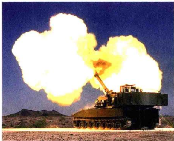
■ M109A6“帕拉丁”可在进入射击阵地后 60 秒内发射第一发炮弹。该火炮通常都采取“打了就跑”的战术，以防止敌方反炮兵火力的打击。
