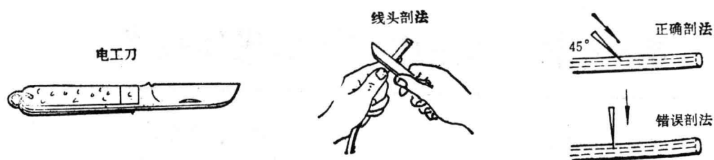
图1—2 电工刀及使用方法
