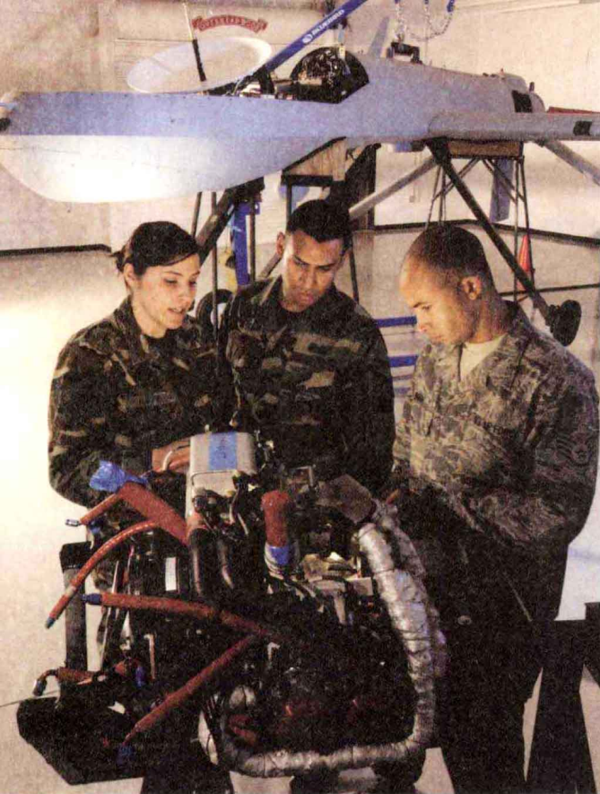
左图：2008年10月15日，丽贝卡·哈特菲尔德中士（左）——加州空军国民警卫队第26场站维修训练小组教员，向卡洛斯·巴雷拉（中）、亚历克斯·布什中士讲解MQ-1“捕食者”Rotax发动机的组件，他们是第163侦察联队的机组组长。（美国空军，瓦尔吉姆彼斯摄）
