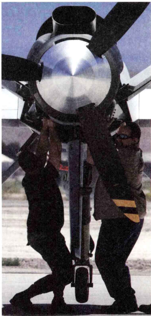
右图：美国空军技术中士马特·马尔卡和空军工程技术服务教员马蒂·安德森（右），在内华达州克里奇空军基地修理MQ-9“收割者”无人机的发动机。（美国空军，兰斯·张摄）
