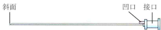
图 2-1 昆克型(Quincke type)脊柱穿刺针。斜面是开放式的,邻近针尖。穿刺针尾有槽口,是一凸出物或者凹槽,并和针尖斜面相一致。当穿刺针嵌入到组织中时,槽口用于标记穿刺针可能的潜在方向及路径
