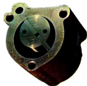
左：真空唧筒和唧筒中的圓柱偏心輪(下圖)。偏心輪嵌置在偏離圓柱形空腔中心點的位置，藉著將空氣抽離進氣閥，而製造真空狀態。這些抽離容器的氣體，會通過一條管子被送往外界。
