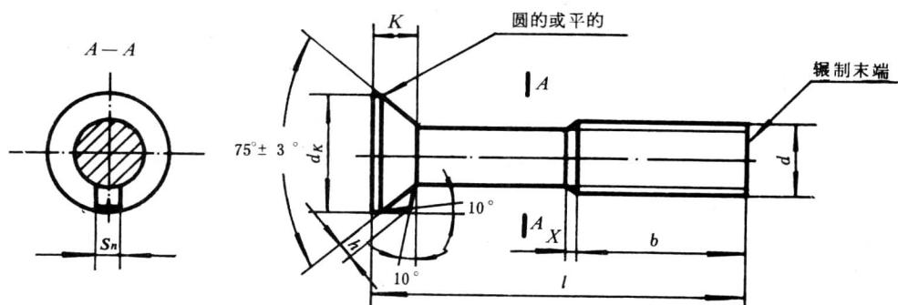
末端按 GB 2 规定；无螺纹部分杆径约等于螺纹中径或螺纹大径。
