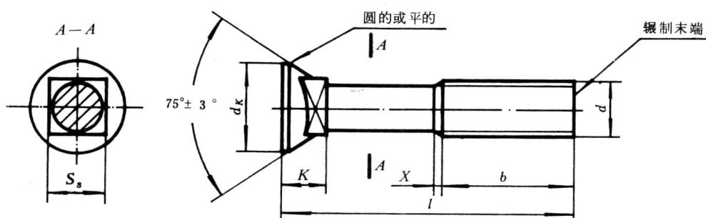
末端按 GB 2 规定；无螺纹部分杆径约等于螺纹中径或螺纹大径。
