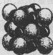
图 2-2 岩盐的晶格构造
