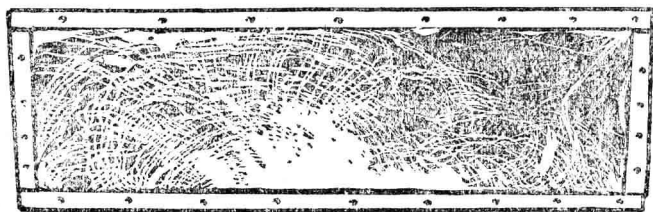
安全玻璃破碎后的样子
