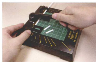
▲这是用于塑胶切割的切纸机。可以方便地切割出一定角度与长度的零件。
