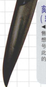
▲实际上P型刀更多地用于在零件表面勾勒或重刻凹线。
