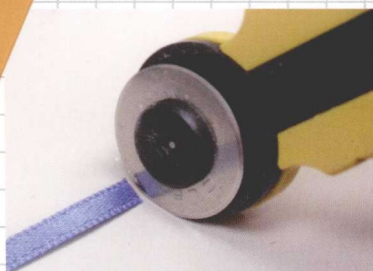
▲按在材料上来回切割。图中为切断彩带的效果。
