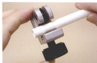
▲通过在截管器中来回旋转，可以很轻松地沿着切线折断塑胶管。
