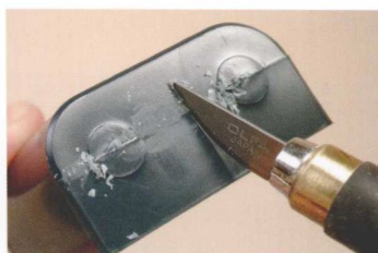
▲使用弧形刀片来消除分模线。优点在于可以仅切削特定部分。
