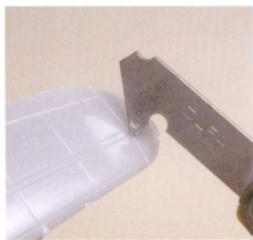
▲实际上P型刀更多地用于在零件表面勾勒或重刻凹线。
