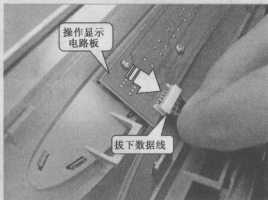
图 1-12 拔下操作显示电路板与主控电路板的数据线
