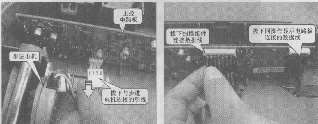
图 1-17 拔下主控电路板连接引线和数据线
