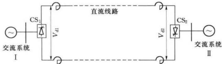
图 0-3 简单直流输电系统原理图
