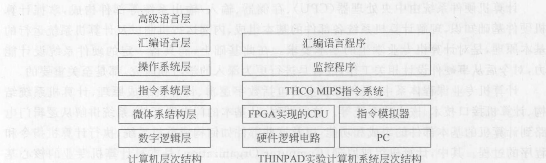
图1 THINPAD 实验计算机系统层次结构图
