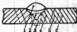
图 7 焊后经高温回火处理后的焊接接头的热影响区的分布
