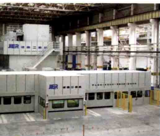
为上海通用东岳汽车公司提供的自动化双臂快速冲压线
