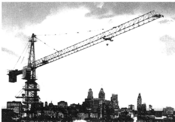
图 1-6 运用力矩平衡原理的塔吊
