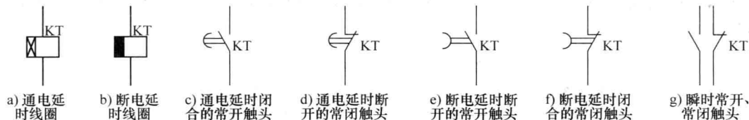
图 1-12 时间继电器的图形符号和文字符号
