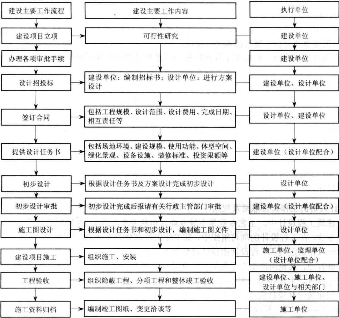
图 1-1-3 设计工作与建设项目的关系
