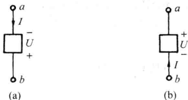
图 1.8 U 、 I 非关联时电路标注
