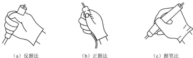
图 1.2 电烙铁的 3 种握法
