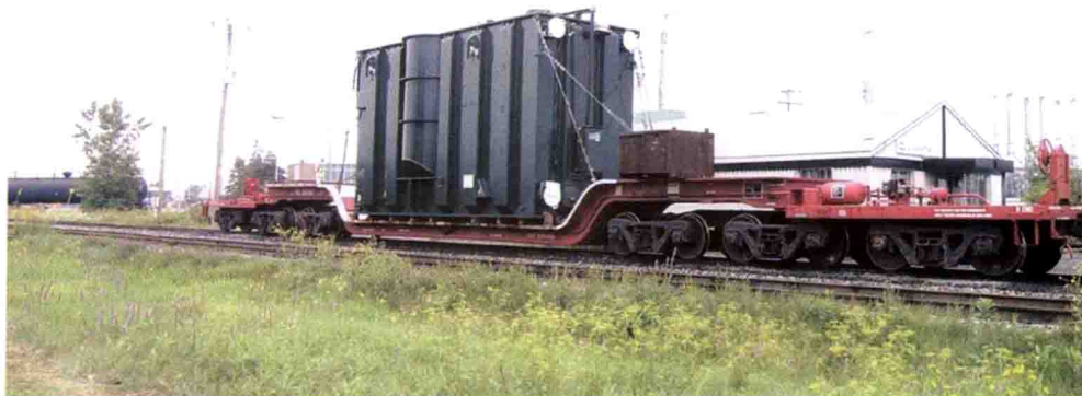
图 1-6 美国铁路 12 轴 KRL 型凹底平车运输小型变压器(2008 年)
