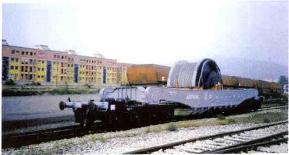
图 1-8 美国铁路 8 轴落下孔车运输卷轴
