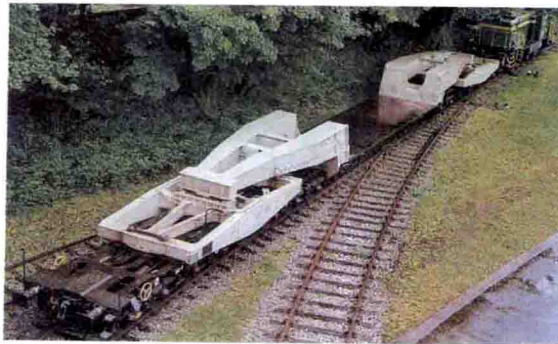
图 1-4 德国铁路 16 轴 Uaai 823 型凹底平车
