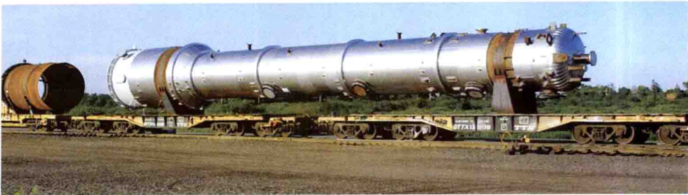
图 1-9 两个 8 轴长大平车跨装运输大型容器的装载图
