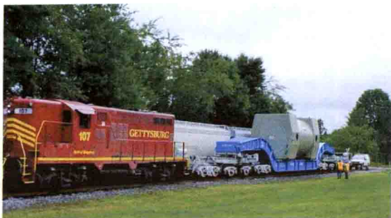
图 1-5 载重量最大的 GEX80003 型 20 轴凹底平车重车编组运输
