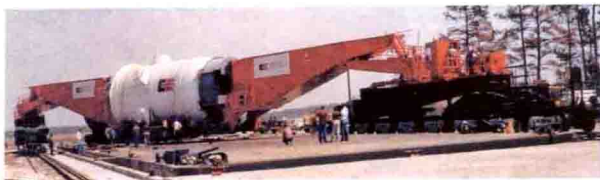
图 1-1 位于两条线路上的 CEBX 型载重 807 t 钳夹车由船上对角接收大型原子能设备
