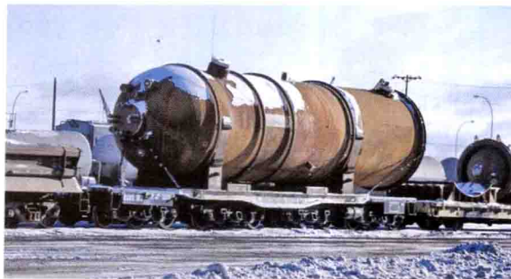
图 1-7 美国铁路 12 轴 BAWX 型长大平车运输锅筒
