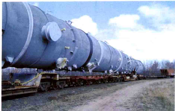
图 1-2 长大容器的铁路运输
