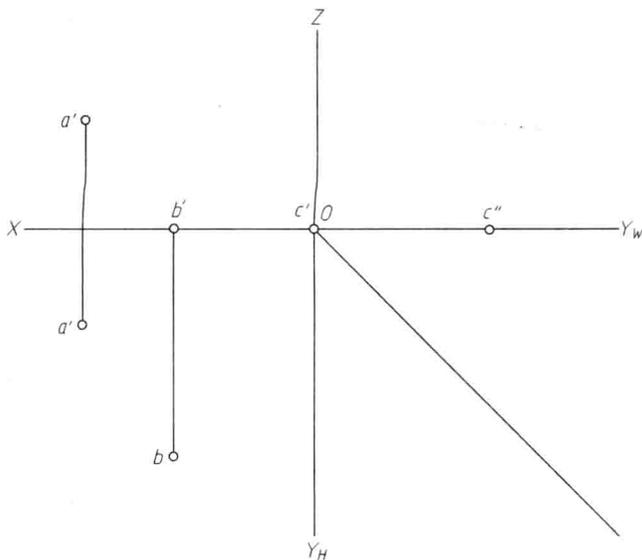
2-4 已知点A的三面投影，点B在点A左10、上10、前5，点C在点A正下方10，求作点B、点C的三面投影。
