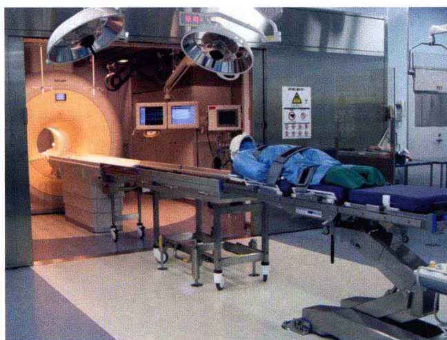
图 1-7 日本 Tokai 大学术中磁共振系统 双室设计，术中扫描时应用转运床将患者运送至诊断室进行扫描
