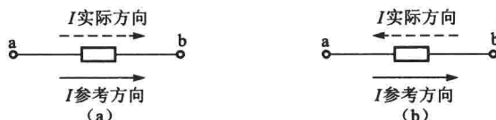
图 1-3 电流参考方向与实际方向的关系
