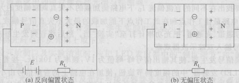
图 1.5 光电二极管的结构及工作方式
