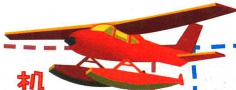
能在水面起飞、降落和停泊的飞机。用于海上侦察、巡逻、反潜、轰炸、布雷、救护和运输等。水上飞机主要分为船身式水上飞机和浮筒式水上飞机两种。
