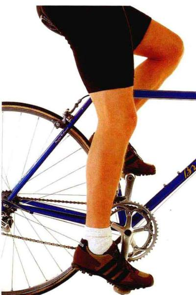
当前脚掌踩在脚踏上，该侧的腿应该略有弯曲。图中的车手使用了骑行锁踏和锁鞋，这样可以保证前脚掌一直在正确的位置。
