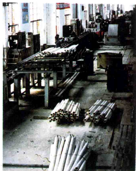
江西钢厂不锈钢管拉拔机组
