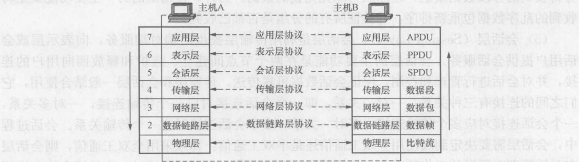
图 1-8 OSI 参考模型中各层数据名称对应图
