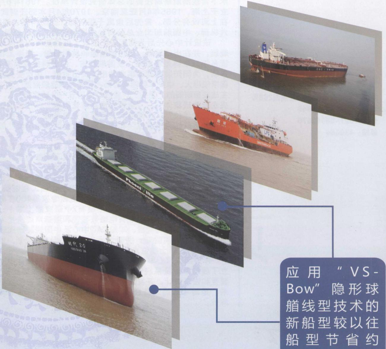
应用“VS-Bow”隐形球艏线型技术的新船型较以往船型节省约15%燃油费。
