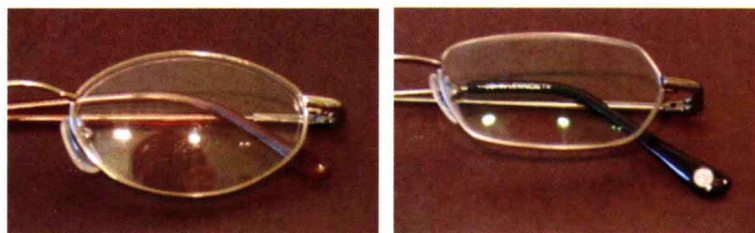
图 14 没有镀消反射膜(左边)和镀有消反射膜(右边)的眼镜的对比,注意左边眼镜所反射的摄影师的像和右边眼镜带颜色的反射。图片引自 http://en.wikipedia.org/wiki/Optical_coating ,由 Justin Lebar 拍摄。
