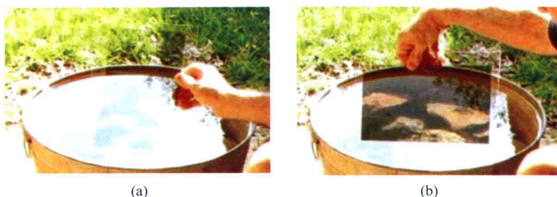
图 26 当太阳光以接近于起偏振角的角度入射到水面时,反射光几乎是线偏振光。(a)若偏振片允许全部(几乎是线偏振的)反射光通过,可以看到水面上的炫光。(b)用一个透光方向竖直的偏振片可以屏蔽掉反射的炫光,就能看到水下面的情景。图片引自 http://polarization.com/water/water.html 。
