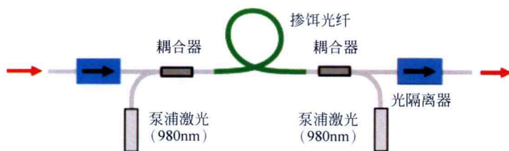
图 30 一个简单的掺铒光纤放大器的原理图, 其中用了两个激光二极管(LD)为掺铒光纤提供泵浦功率。图片引自 http://www.rp-hotonics.com/erbium_doped_fiber_amplifiers.html 。
