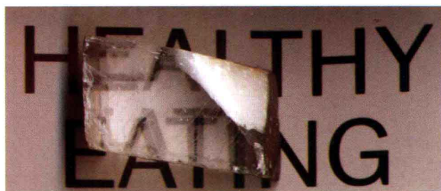
图 27 一块方解石晶体放置在纸上方,有些字母显示出双折射。图片引自 http://en.wikipedia.org/wiki/Photon_polarization 。
