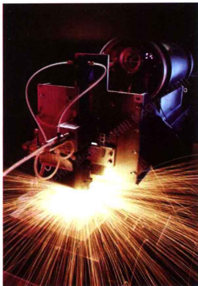
图 33 一个安装在机器人系统上的 2kW 光纤激光器在切割低碳钢。图片下载自因特网。
