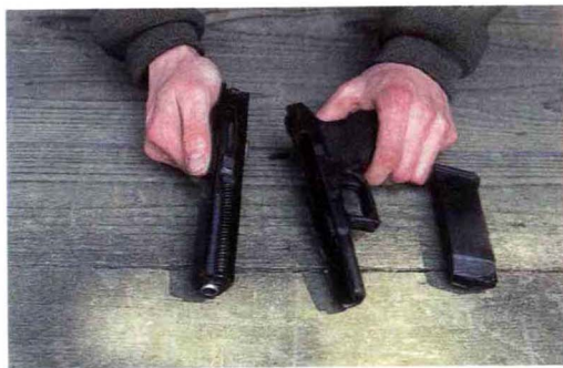
▲ 格洛克手枪的设计极其简单，仅有33个零部件，易于拆卸和清理，具有较高的军事用途。
