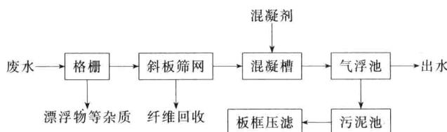
该工艺在进水 COD 为 1000~1200mg/L, SS 含量在 800~1200mg/L 的情况下，COD 的去除率  $\geq 65\%$ ，出水水质 COD 浓度小于 350mg/L, SS 小于 100mg/L，低于排放标准。该工艺的每吨废水处理费用为 0.36 元，其中药剂费 0.18 元，每日用电约 110kW·h，每度电按 0.55 元计，则每吨废水电费为 0.09 元，人工费（4 人）每吨废水 0.09 元。本方案工程总投资估算约为 30 万元。
