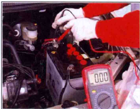
蓄电池电极桩检测的连接方法
