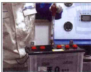
用密度计吸取蓄电池中的电解液
