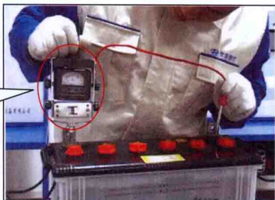
用高功率放电计量出的蓄电池空载端电压
