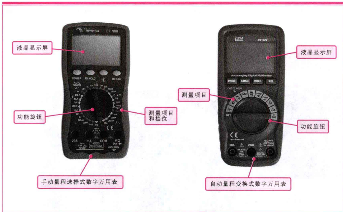
图 1-3 典型数字万用表的外形结构
