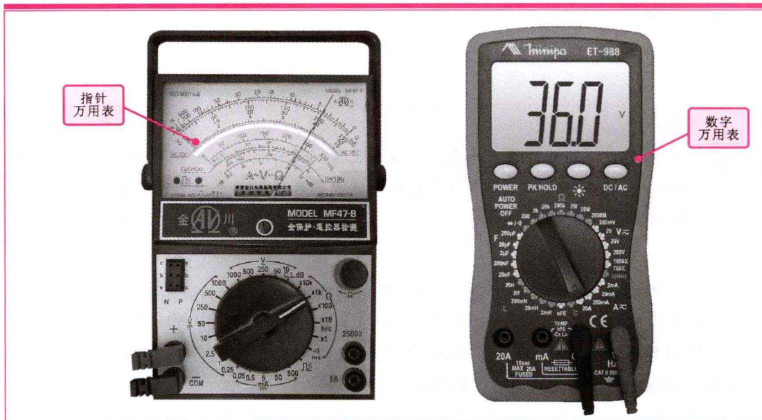
图 1-1 典型万用表的实物外形
