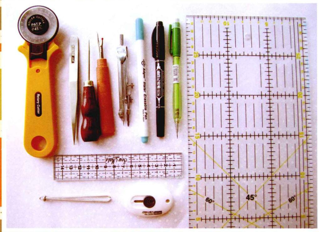
上：45mm轮刀、镊子、锥子、拆线器、圆规、水消笔、记号笔、铅笔、拼布尺
