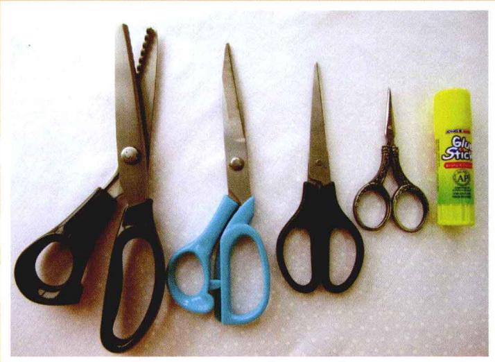
从左至右：花边剪（剪牙口时可以轻松使用）、布剪（剪裁布料、铺棉、硬衬类使用）、纸样剪（制作纸样时使用）、线剪（绣花、剪线头时使用方便、小巧）、胶棒（贴布时使用方便、快捷）
