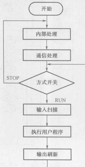
图 1-2-7 PLC 的扫描工作过程
