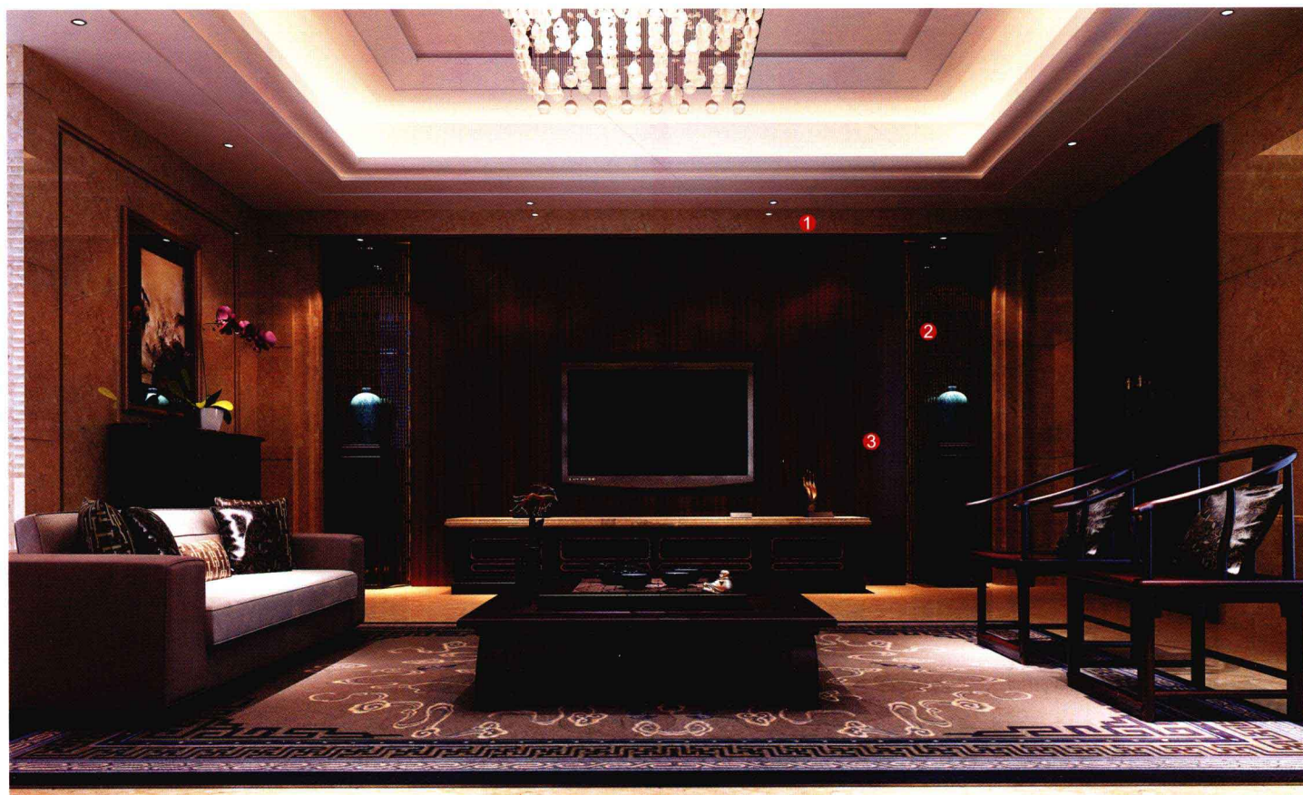
1 米黄色网纹大理石 2 镜面陶瓷锦砖 3 红樱桃木饰面板
