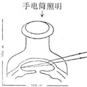
图13 使用半只链霉素瓶观察 \alpha 象
