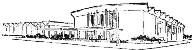
图 1.1.12 郑州第二砂轮厂食堂折板结构
