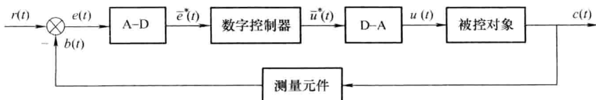
图 8-1 数字控制系统典型原理图
